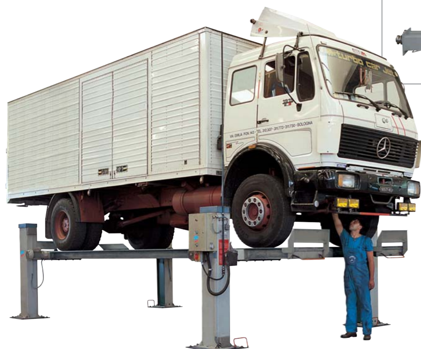
KP 442E DC - 12 t - 8000 mm KP 442NE DC - 14 t - 8000 mm KP 440E DC - 20 t - 8000 mm
